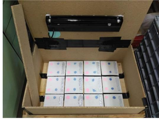
Figura 3.13 - Provetes colocados à exposição solar numa estrutura metálica (à esquerda) e a caixa de madeira para a exposição à radiação UV-A (à direita).
