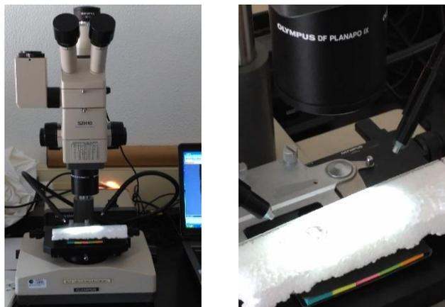
Figura 3.5 - Microscópio utilizado para observar as amostras (à esquerda) e observação da secção transversal da solução ETICS no microscópio (à direita).
