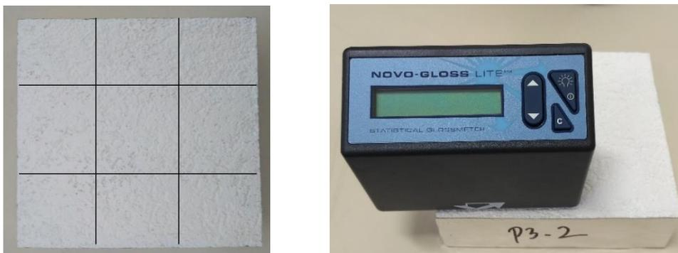
Figura 3.9 - Representação esquemática com retas pretas dos quadrados para identificar as zonas para medir o brilho (à esquerda) e medição do brilho com o equipamento (à direita).
