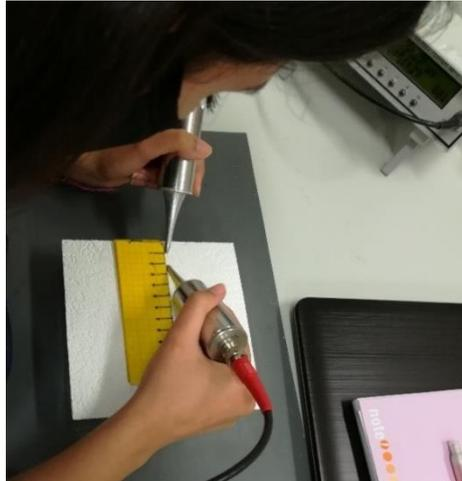
Figura 3.6 - Realização do ensaio de ultrassons pelo método indireto, com o auxílio de uma régua.
