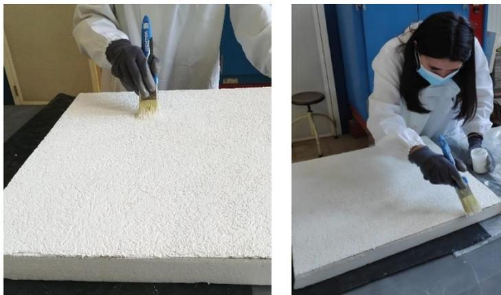
Figura 3.1 - Aplicação do produto com trincha em banda na placa ETICS
