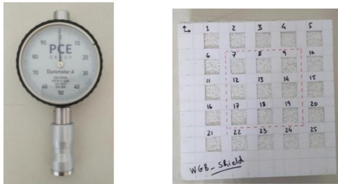
Figura 3.7 - O durómetro para realizar o ensaio (à esquerda) e a grelha utilizada em cada provete (à direita).
