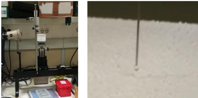
Figura 3.8 - O equipamento para a medição do ângulo (à esquerda) e a aplicação da microgota na superfície em análise (à direita).
