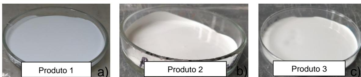
Figura 3.4 - Discos de petri identificados com a respetiva tinta, onde representa o ensaio do resíduo seco do a) P1, b) P2 e c) P3
