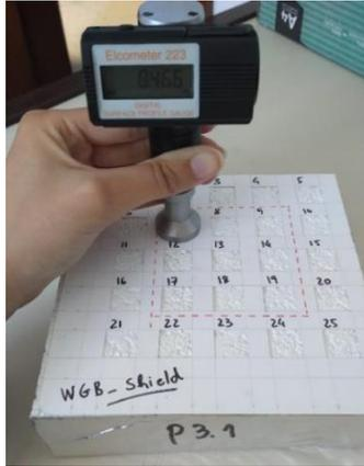
Figura 3.10 - Medição da rugosidade da superfície do provete com o rugosímetro recorrendo ao auxílio da grelha.
