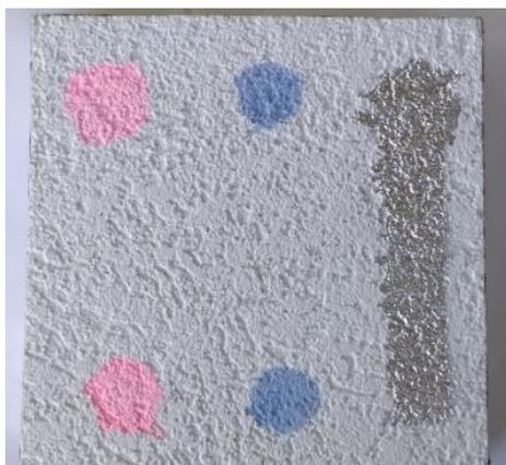
Figura 3.12 - Exemplo de um provete com 2 ndoas de rodamina B(RhB), 2 ndoas de azul de metileno (MB) e *graffiti* prateado.
